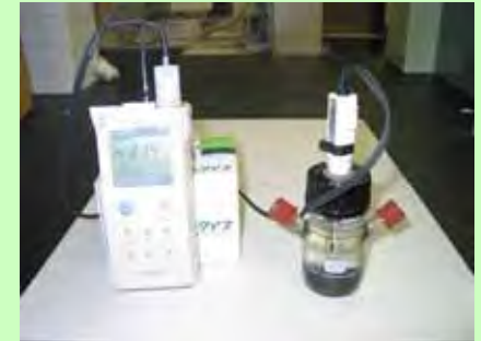
実験の様子(気密バイアル瓶に電極を差し込み、酸化還元電位を測定)
